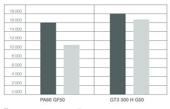
■ Tensile-E-Modulus / dry [MPa] ■ Tensile-E-Modulus / conditioned [MPa]
